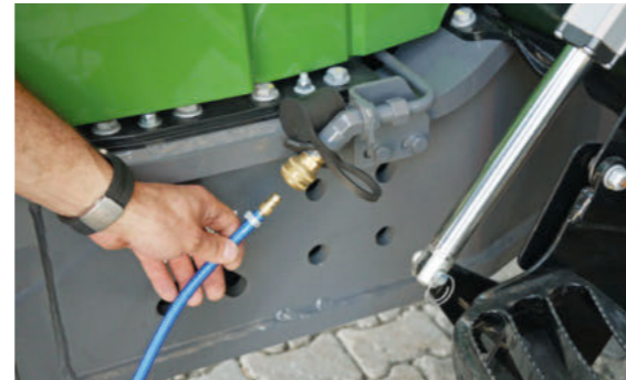
Sulla parte anteriore della macchina è presente un raccordo dell'aria compressa.
