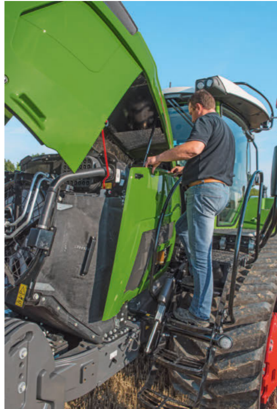
Il vano motore è molto accessibile con i pannelli laterali rimovibili.
