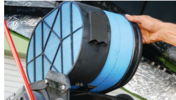
Il filtro aria è semplice da sostituire ed è dotato di un sensore dello sporco che fornisce informazioni sull'efficacia del filtro.
