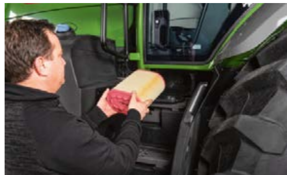
Il filtro della cabina è posizionato in un punto facilmente raggiungibile nell'area d'ingresso per poter essere pulito facilmente al bisogno.
